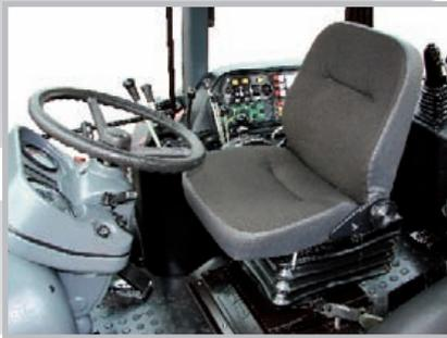
Безопасная, с гнутыми фасонными профилями каркаса и гнутыми стеклами, соответствует требованиям ОЕСД, с фильтрацией и подогревом подаваемого в кабину воздуха, с открывающимися боковыми и задним окнами, люком в крыше, с электрическими стеклоочистителями и омывателями лобового и заднего стекол, с реверсивным постом управления, кондиционером, двумя фарами спереди, четырьмя сзади, проблесковым маячком.
