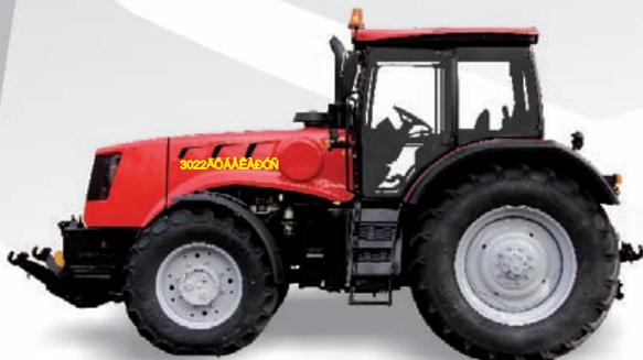
Тракторы оборудуются задним и передним навесными трехточечными устройствами большой грузоподъемности.
