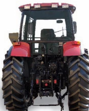
На тракторе применено лифтовое устройство, которое предусматривает установку различных тягово-сцепных устройств с возможностью изменения их положения по высоте.
