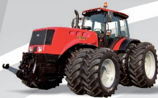
Тракторы «БЕЛАРУС» 3022ДЦ/3022ДЦ.1 и их модификации представляют собой тракторы общего назначения тягового класса 5 с колесной формулой 4x4.
