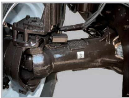
Передний ведущий мост: соосный, балочного типа, с самоблокирующимся дифференциалом повышенного трения, с планетарными колесными редукторами и двухопорными поворотными цапфами. Фрикционная муфта с электрогидравлическим управлением позволяет включать мост под нагрузкой и обеспечивает три режима работы: включен автоматически; включен постоянно; выключен.
