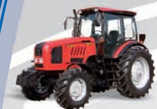
Трактор «БЕЛАРУС-2022» и его модификации представляют собой тракторы общего назначения тягового класса 3 с колесной формулой 4x4.
