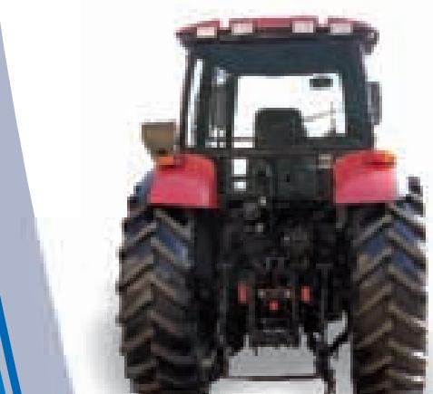
Тяги оснащены быстросоединяемыми устройствами, которые обеспечивают удобное присоединение машин с размерами шарниров по кат. 3 (НУ-3) и по кат. 2 (НУ-2) путем замены автономных шарниров.
