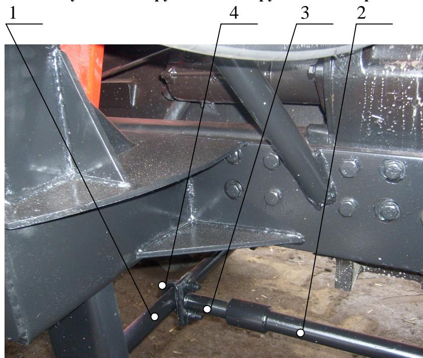
**Рисунок 2. Оборудование погрузочное. Установка Распорного вала и Разгружающего устройства.**
