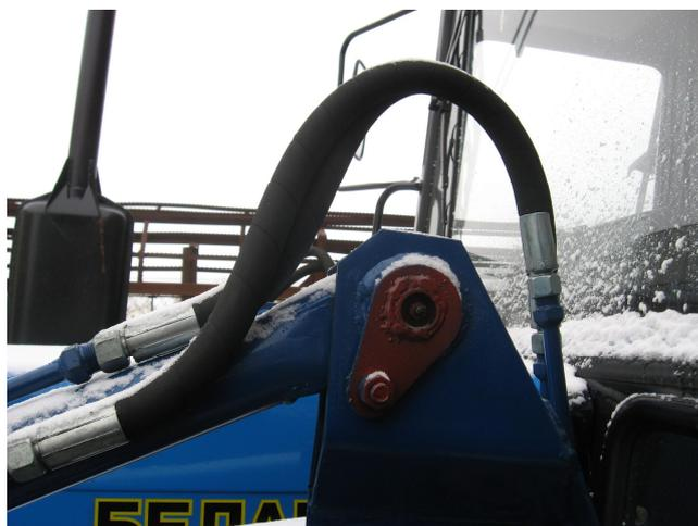
**Рис.10 Подключение ковшевых гидроцилиндров.**
