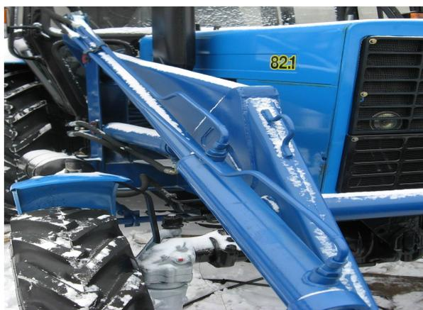
**Рис.11 Подключение ковшевых гидроцилиндров.**
