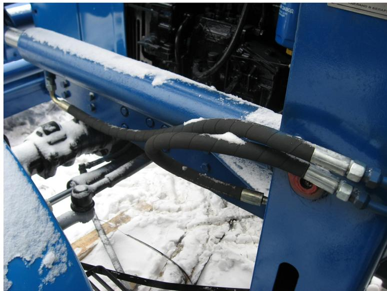
**Рис.8 Подключение стреловых гидроцилиндров.**
