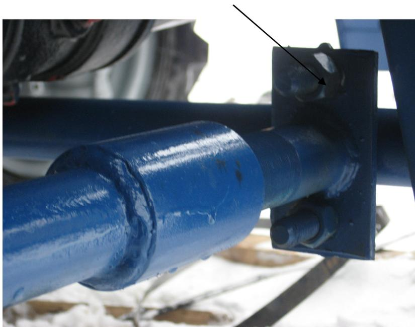
**Рис.5 Установка Винта на Вал распорный.**
