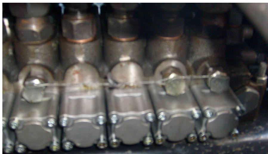
**Рис.7 Пломбирование гидрораспределителя
