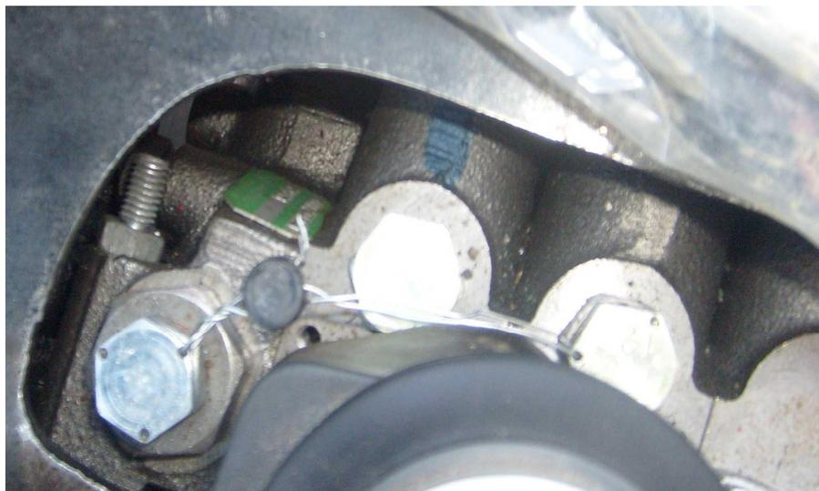
**Рис.6 Пломбирование гидрораспределителя
