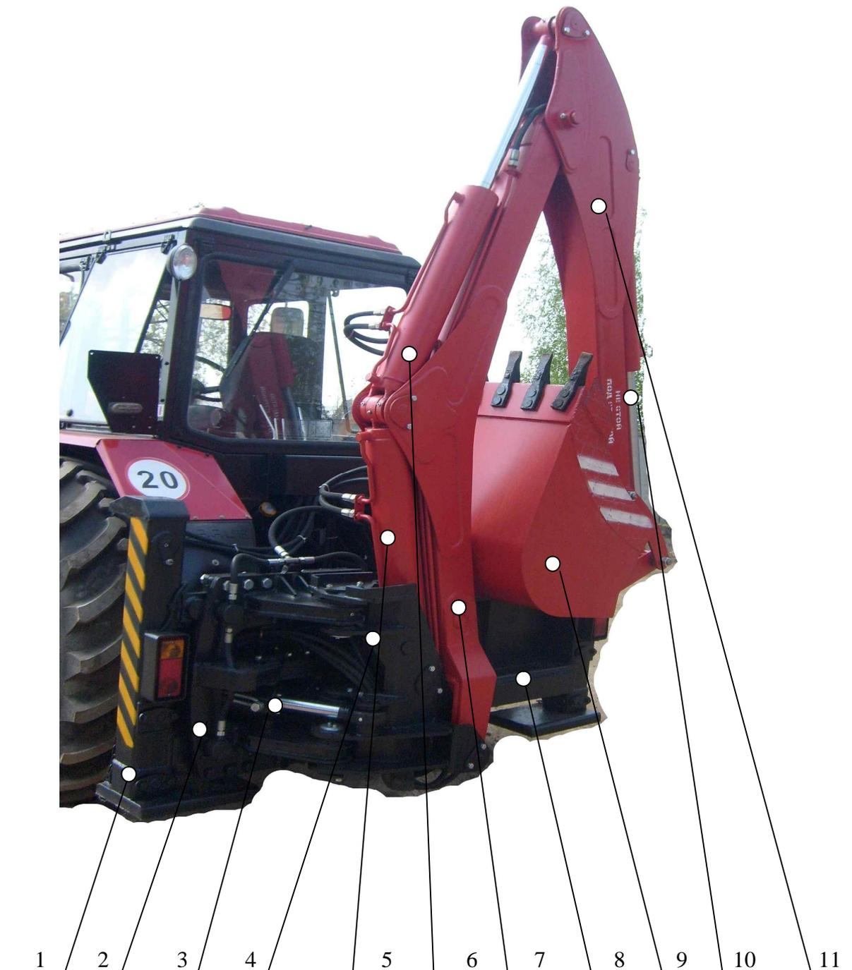
**Рис.1** Общий вид и основные узлы экскаваторного оборудования:
