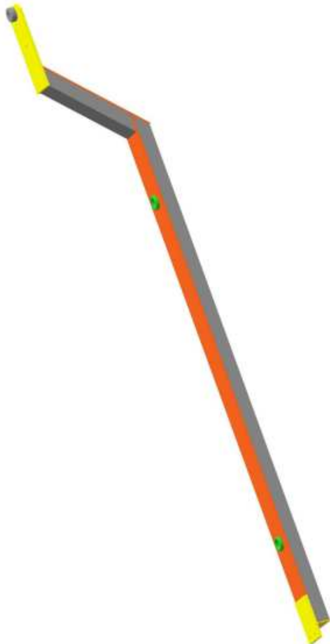
Рисунок 2. Балка боковая НБУ-1300.10
